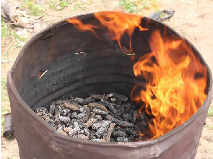
Rafles de maïs en fin de pyrolyse (biochar)
